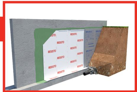
Il est recommandé d'installer un panneau de protection tel que SOPRA-XPS si le sol est argileux ou pour protéger la membrane lors du remblayage.
